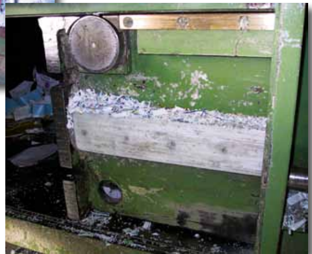
Seitliche Führungsleisten und -rollen bearbeiten und ersetzen
