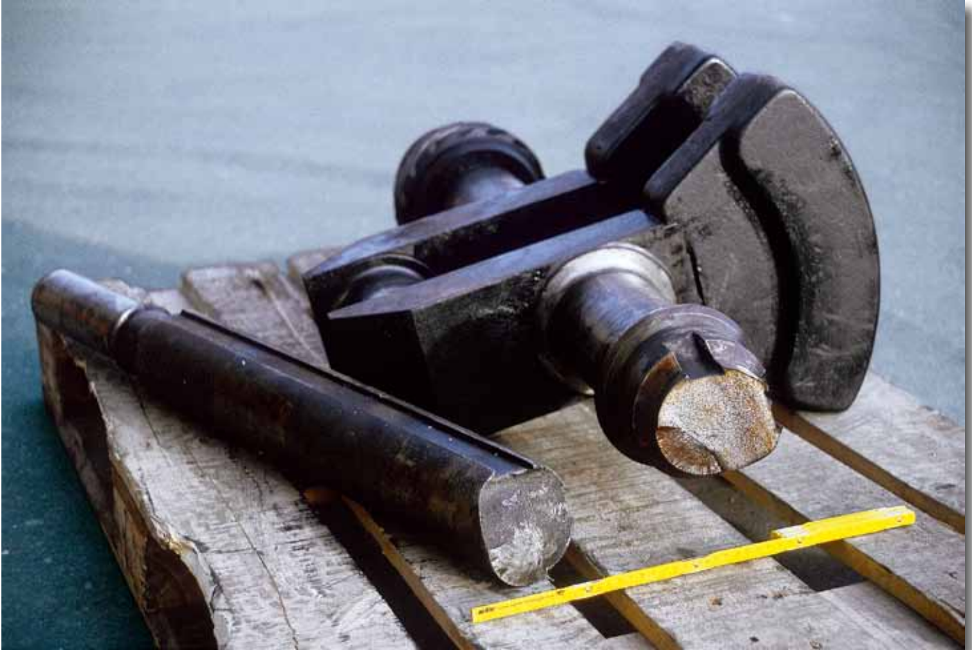
Abgebrochene Lagerzapfen abgetrennt und neuen Zapfen angesetzt
