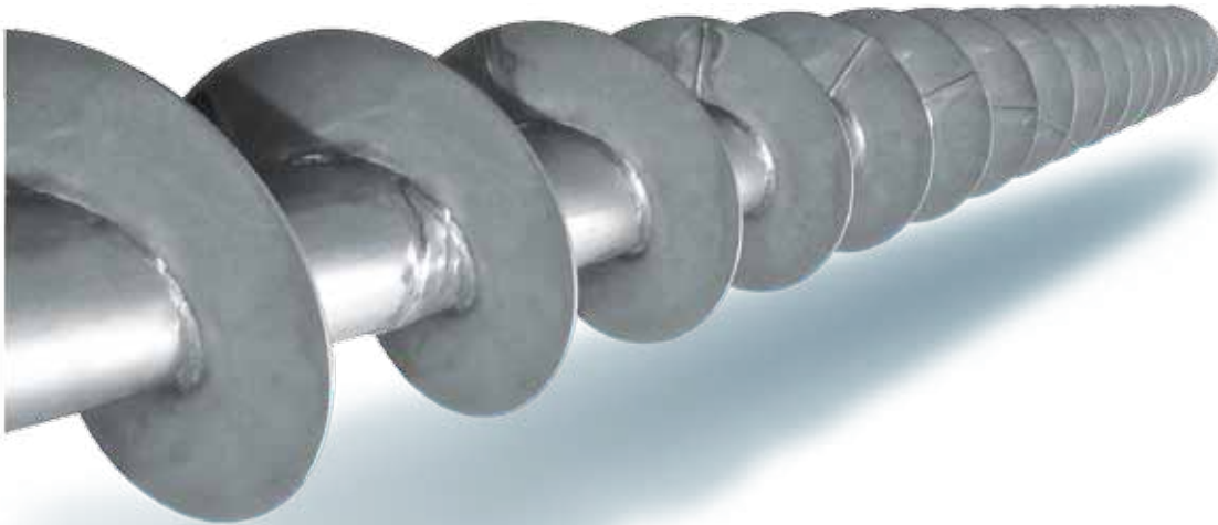
Förderschnecke nach Einschweißen der neuen Förderbleche
