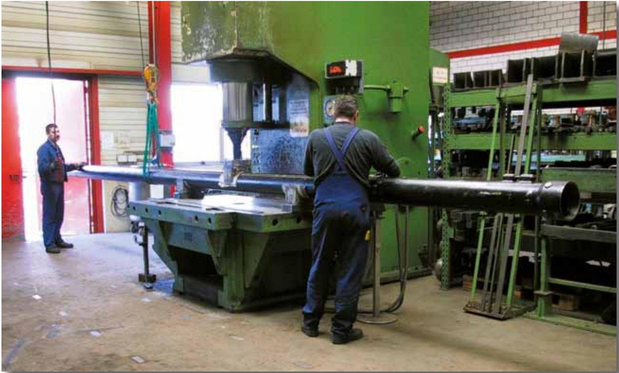
Zylinderrohr von einem Autokran zur Instandsetzung
