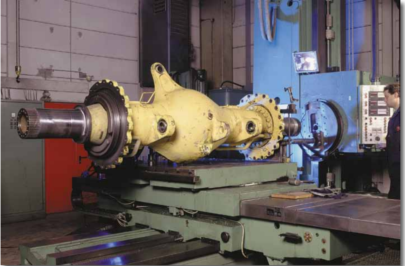
Aufarbeiten der Lagersitze an einer Antriebsachse eines Muldenkippers
