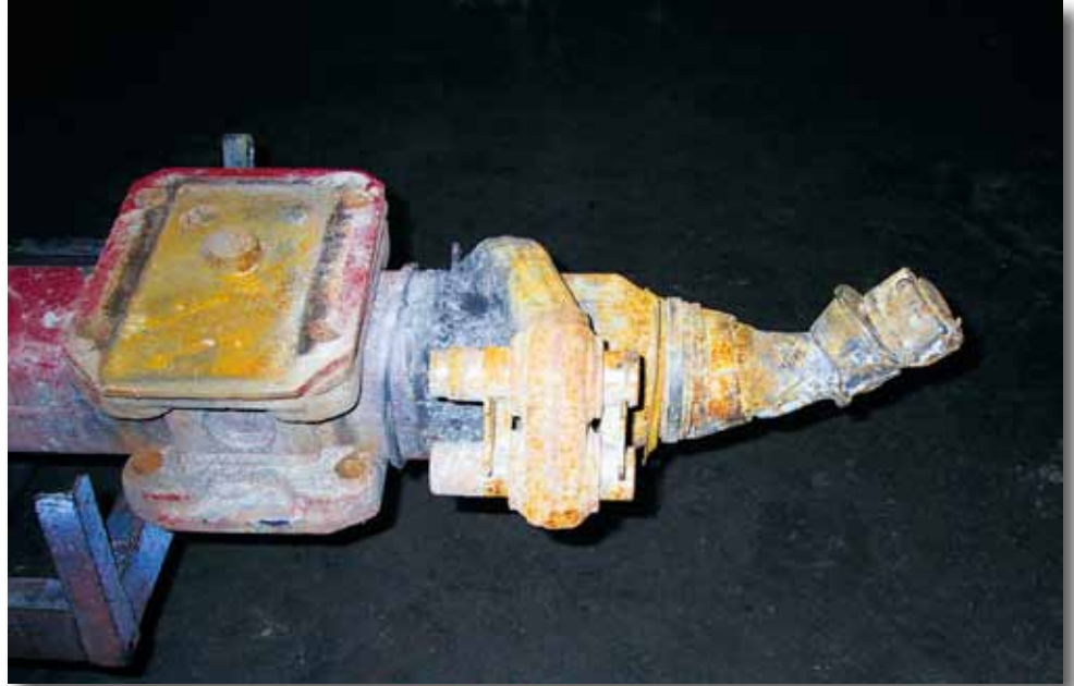
Gewaltschaden an Anhängerachse
