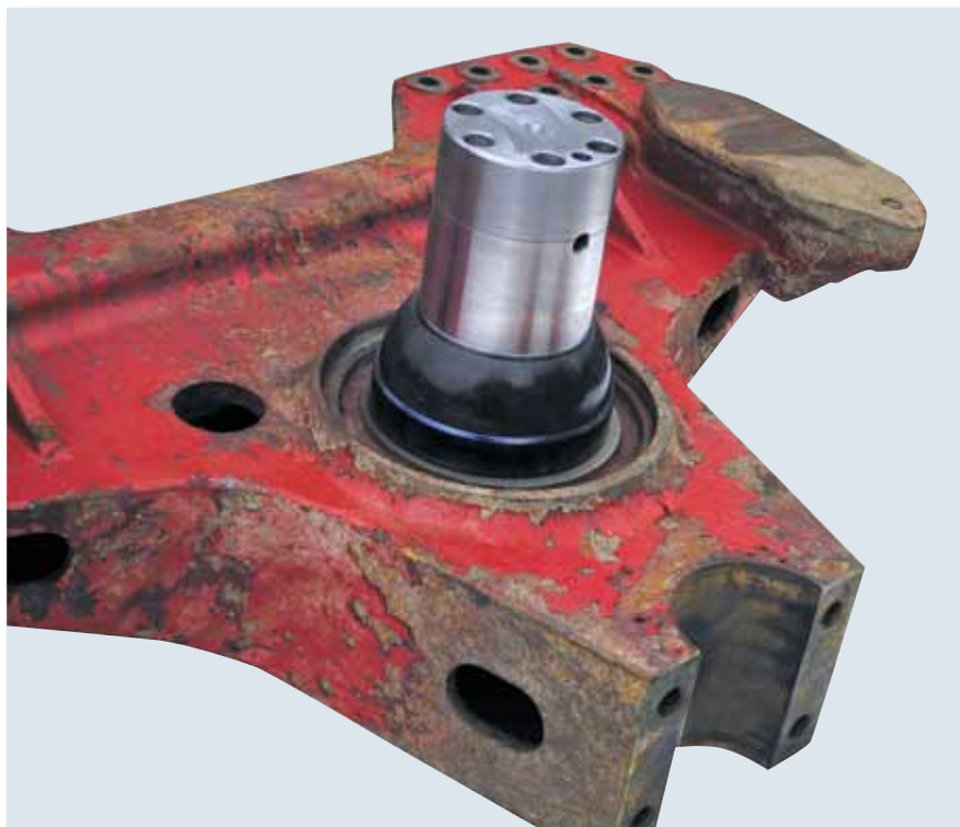
Erneuern eines Achsstummels an einer Tragachse
