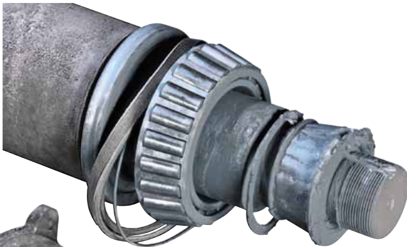
Gewaltschaden an Anhängerachse
