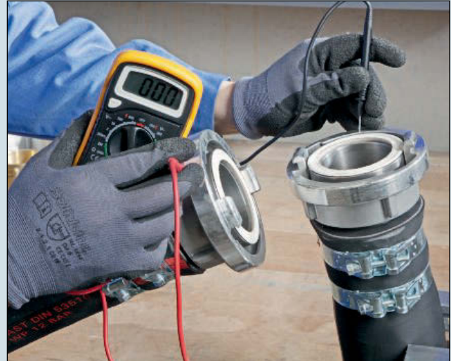
6 Da nichtleitende Schlauchleitungen eine große Gefährdung für Mensch und Umwelt darstellen, wird diesem Punkt eine sehr große Bedeutung beigemessen. Jede Schlauchleitung wird daraufhin geprüft, bevor Sie an Kunden ausgeliefert wird.
