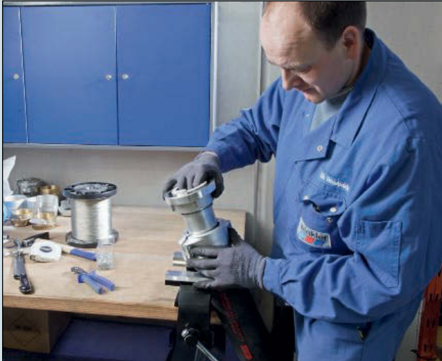
5 Beim Einbringen des Stutzens in den Schlauch wird darauf geachtet, dass die eingebundene Kupplung noch drehbar ist und dass die zur Befestigung verwendeten Schellen bzw. Schalen einen optimalen Sitz haben.
