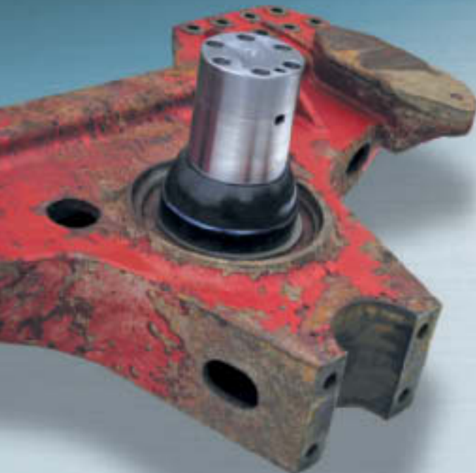
Erneuerter Achsstummel an einer MAN-Stützachse
