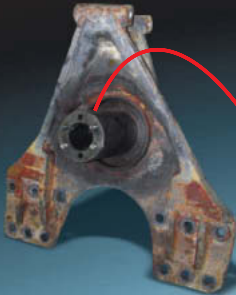
Erneuerter Achsstummel an einer MAN-Stützachse
