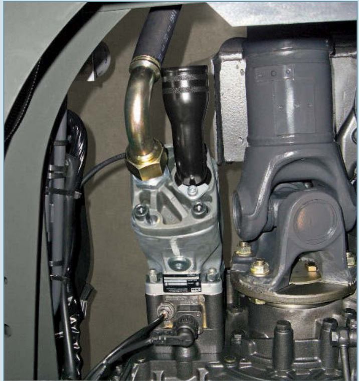
Montageposition des Nebenantriebes neben der Kardanwelle.
